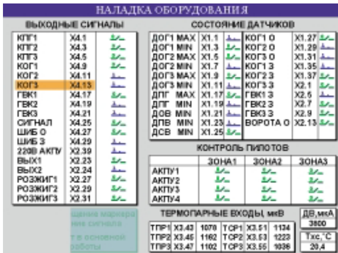
Рис. 5. Вид экрана в режиме наладки оборудования
