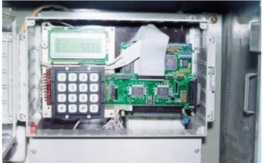
Рис. 6. Внешний вид контроллера со снятой лицевой панелью
