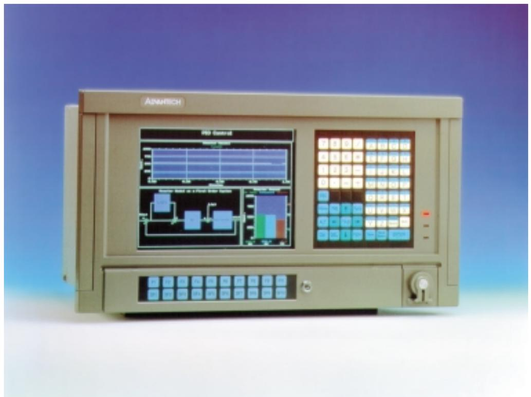
**Рис. 4. Индустриальная рабочая станция AWS-850СТ**
