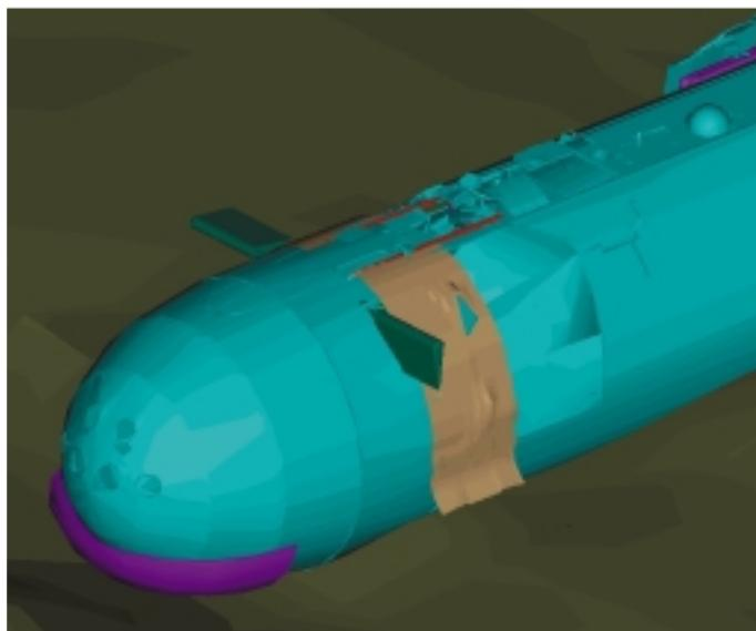
Рис. 6. Компьютерный проект укрытия АПЛ «Комсомолец»
