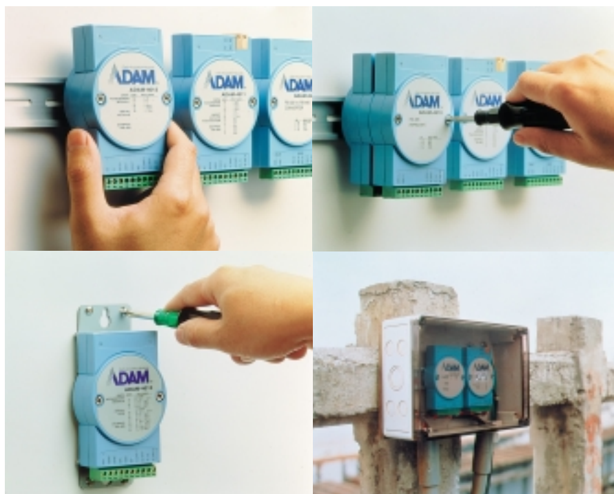
Рис. 3. Внешний вид модулей серии ADAM-4000 и способы их установки
