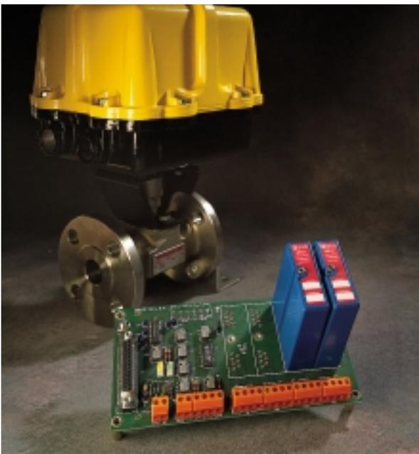
Рис. 6. Модули 6В на монтажной панели 6ВР04-2 с разъемом для подключения интерфейса RS-232
