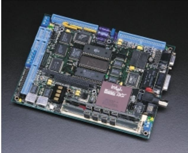
Рис. 6. Одноплатный компьютер фирмы Octagon Systems размером 150 × 200 мм
