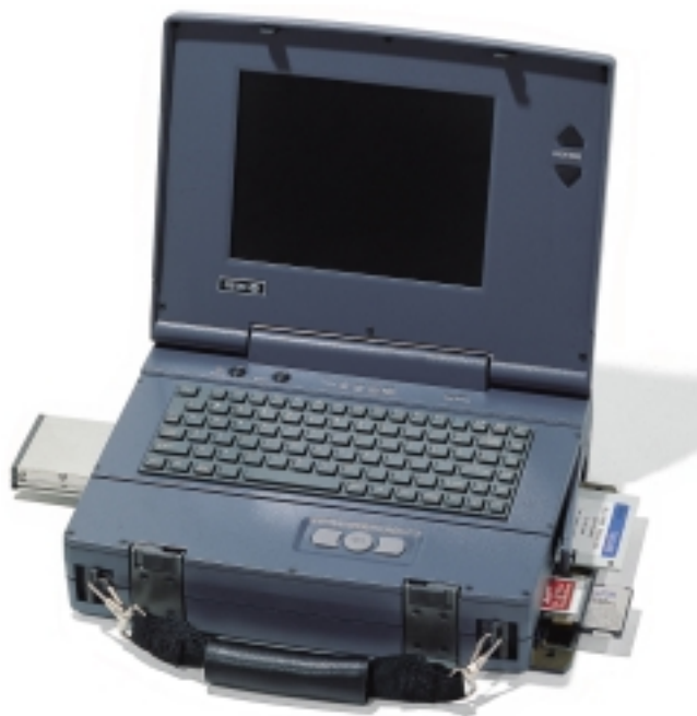
Ноутбук серии IX в исполнении IP66 с установленным модулем расширения
