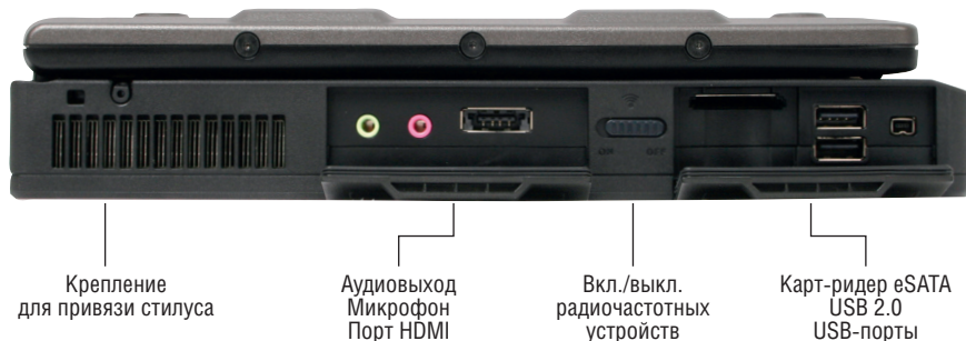
Рис. 6. Расположение портов на левой панели ноутбука S400
