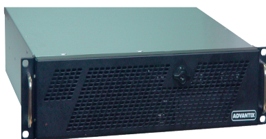
Рис. 5. 2U-станция оператора АСУ IPC-2U-SYS9-A8
