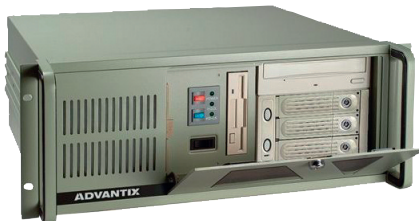
Рис. 4. Высокопроизводительная станция оператора АСУ повышенной надёжности
