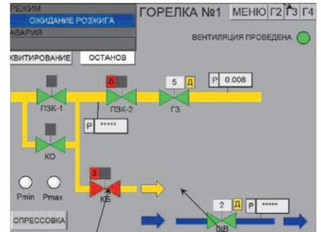
Рис. 7. Мнемосхема подсистемы управления розжигом горелки № 1
