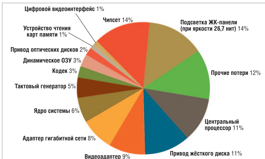
Рис. 4. Анализ структуры энергопотребления для ноутбука с чипсетом на платформе Intel Centrino Santa Rosa
