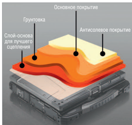
Рис. 6. Структура защитного покрытия корпуса ноутбука
