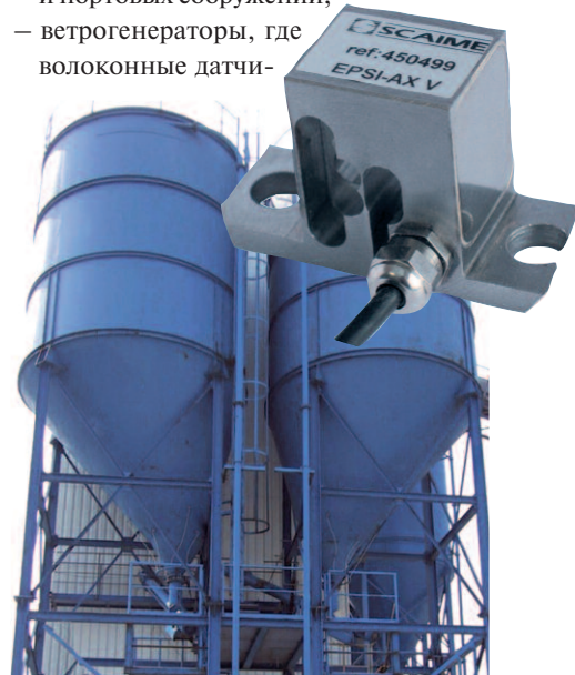
Рис. 9. Контроль деформаций опор бункера
