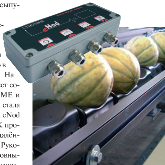
Рис. 11. Высокоскоростные весы на автоматизированной линии сортировки и фасовки фруктов
