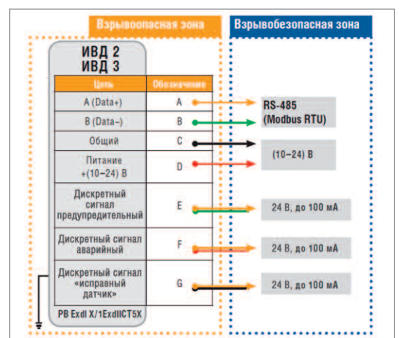
Рис. 5. Схема подключения датчиков с дискретным выходом
