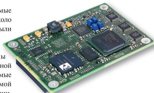
Рис. 1. Внешний вид встраиваемого Ethernet-модуля Hirschmann EES20
