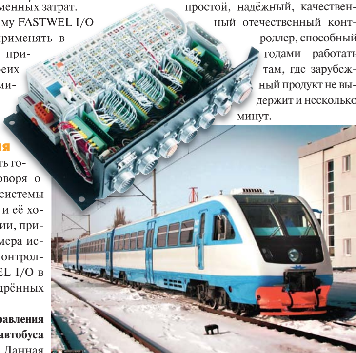
Рис. 8. Рельсовый автобус РА2 и контроллер FASTWEL I/O CPM70101 из состава его системы управления
