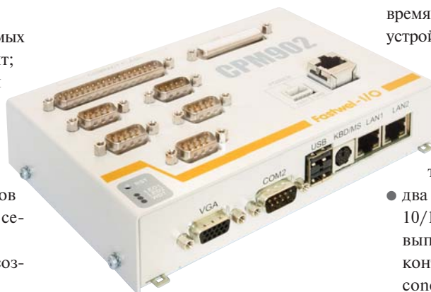
Рис. 4. Универсальный контроллер СРМ902-01
