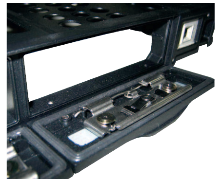
Рис. 4. Крышка отсека промышленного ноутбука
