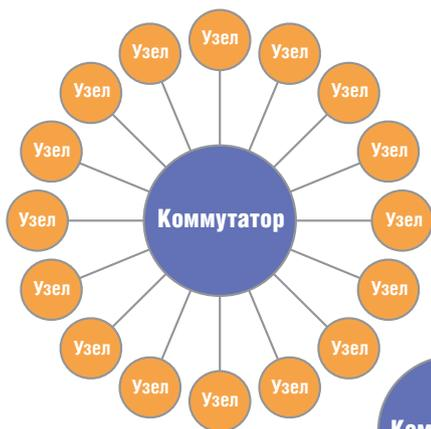
Рис. 9. Сетевая топология типа «звезда»
