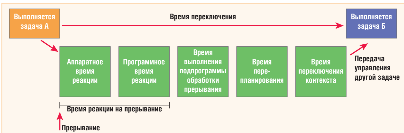
Рис. 1. Реакция ОС на прерывание (с перепланированием)
