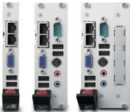
Рис. 2. Варианты исполнения платы sPCI-3610
