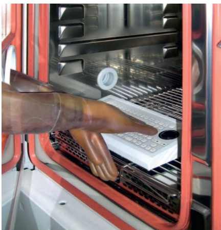
Испытание клавиатуры в климатической камере
