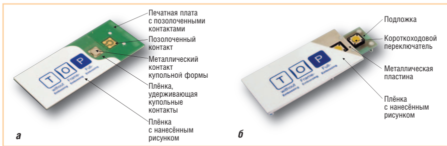
Рис. 1. Конструкция клавиатуры: а) мембранной; б) короткоходовой
