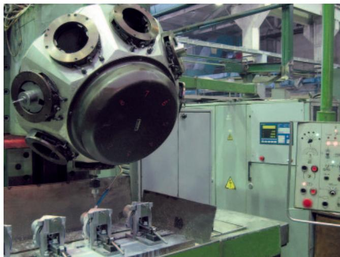
Рис. 4. Станок MA655A3 с заменённой системой управления «Курс»
