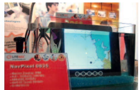
Рис. 5. Дисплей NPD0835, погруженный в воду, продолжает работать
