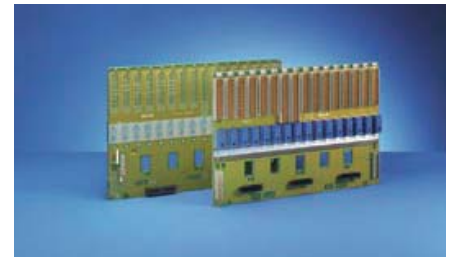
Рис. 7. Задние панели (кросс-платы) системы AdvancedTCA фирмы Schroff
