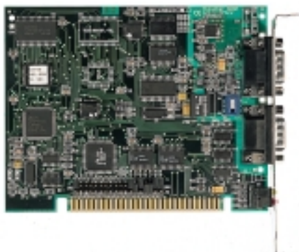
Семейство IBM PC совместимых контроллеров (CIF — Communication InterFace) фирмы Hilscher для построения сетей CANopen, DeviceNet и SDS
