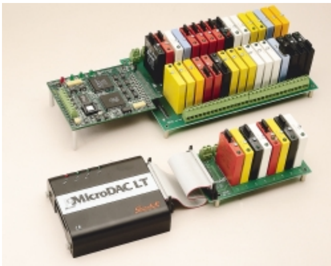
Контроллер DacNet фирмы Grayhill, поддерживающий протокол DeviceNet
