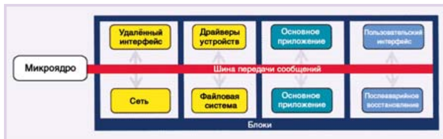
Рис. 2. Группировка программных процессов в виртуальные разделы и передача управляющих воздействий от ядра по шине передачи сообщений
