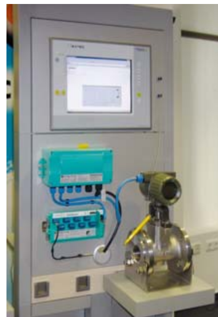
Пример использования ПК VISUEX в составе стенда тестирования датчиков
