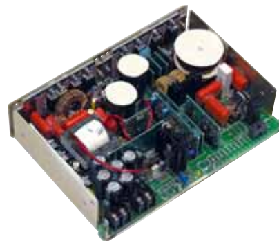
Рис. 2. Внешний вид конструкции DC/AC-преобразователя DAX200-245L1-C (кожух снят)
