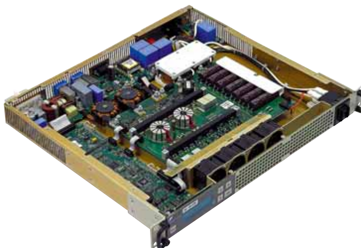
Рис. 7. Внешний вид конструкции инвертора SLI-24-230 (крышка снята)
