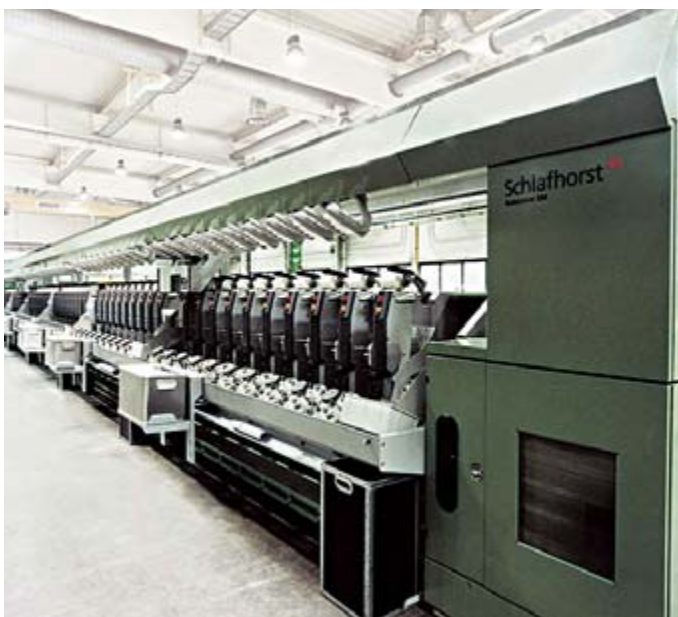
Рис. 15. Общий вид намоточного станка Autoconer 338
