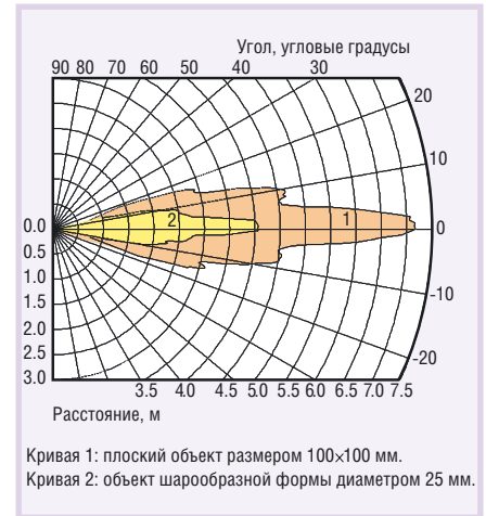
Рис. 11. Детекторная характеристика датчика UC6000-30GM-IU-V1
