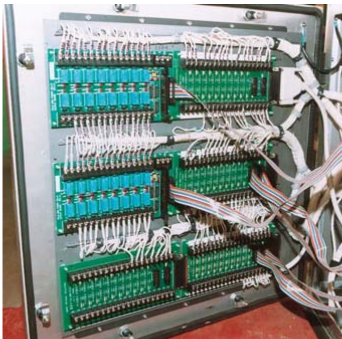
Рис. 2. Подключение сигналов через клеммные платы
