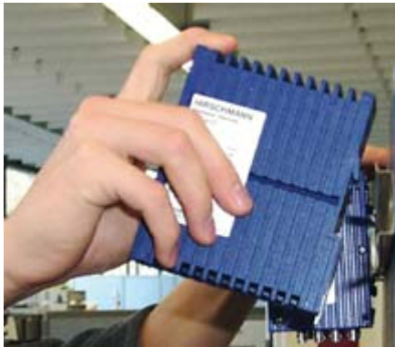
Рис. 1. Монтаж модуля серии Rail на DIN-рельс
