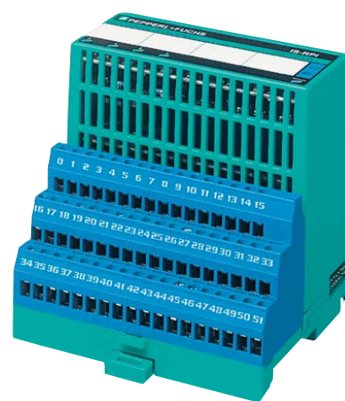
Секция системы IS-RPI с модулем ввода-вывода
