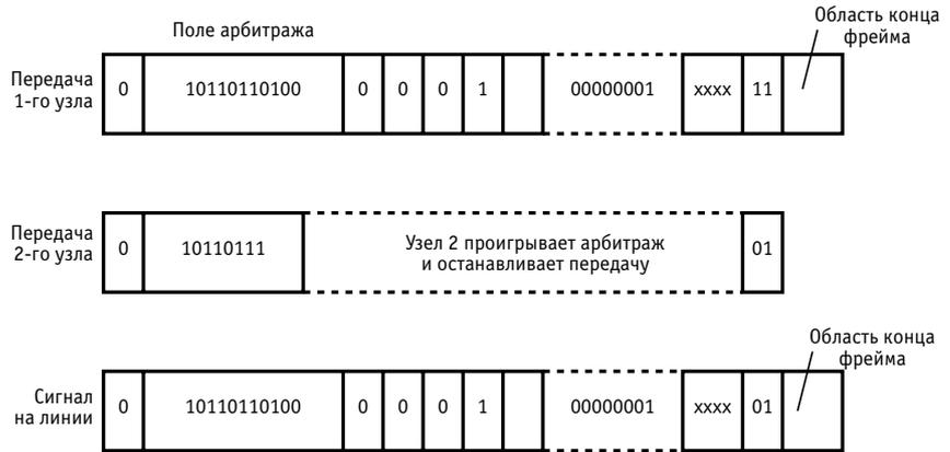
Рис. 6. Пример поразрядного арбитража
