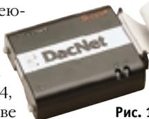
Фирма Hilscher выпускает богатый набор плат с CAN-протоколами (CanOpen, Device Net, SDS) для распространенных системных шин типа ISA и PCI, для мезонинной шины PC/104, а также в виде OEM-модулей (рис. 12) для тех изготовителей контроллеров, которые хотят встроить в свои изделия
