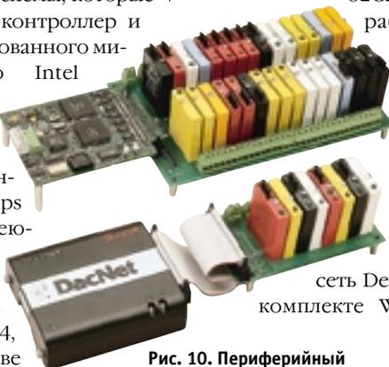
Рис. 10. Периферийный CAN-контроллер DacNet фирмы Grayhill
